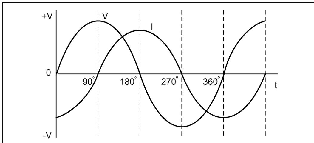
**FIGUUR 3.2: STROOM- EN SPANNINGSGOLFFORME**
